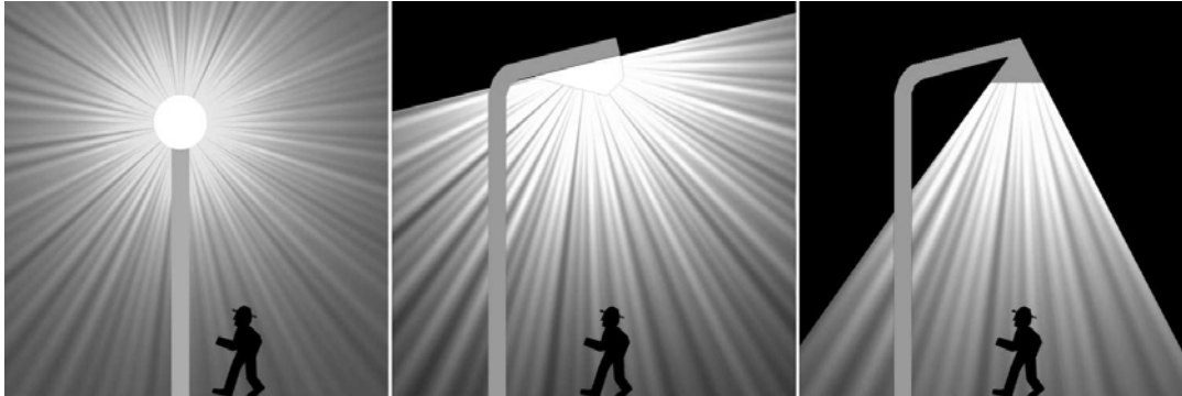
Abbildung 123: Leuchtradien bei Straßenbeleuchtung
